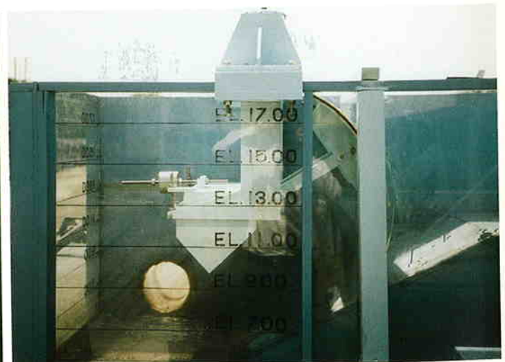
下流水位調節水門 (HLAG-400)
