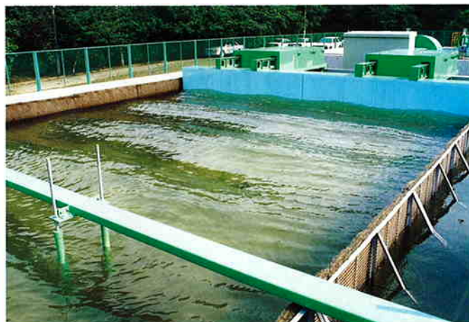
消 波 装 置：三面ビーチ型 観 測 台：2ヶ所、各種計測用
