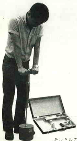
モルタルの貫入抵抗 測定中
