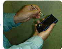
PDAに測定空気量、測定質量を 入力して迅速に単位水量を推定
